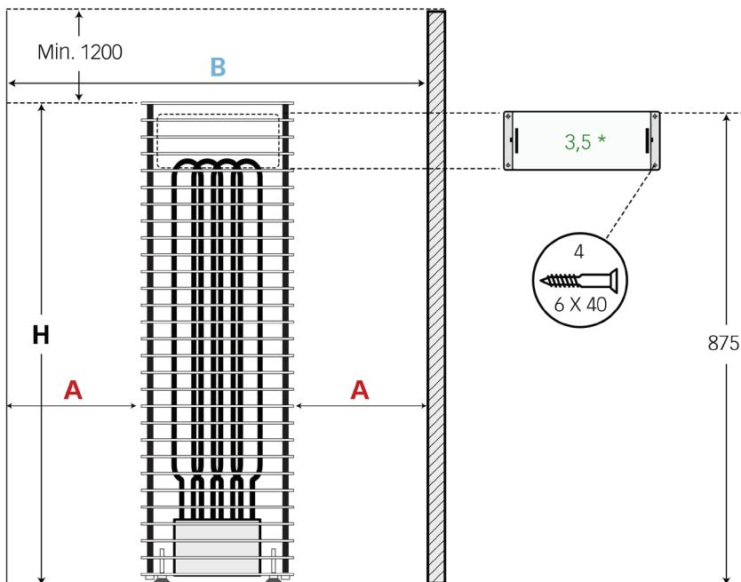
\* CLIFF 3,5 se připevňuje ke zdi pomocí speciálního držáku
