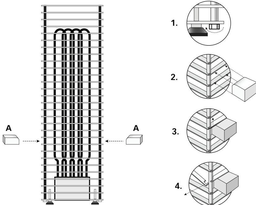
**POZOR!** Žebro z ohřívače sejměte přímým pohybem, aniž byste žebrem otáčeli nebo používali sílu. Dejte pozor, abyste neohnuli místa spojení žebra s ohřívačem.
