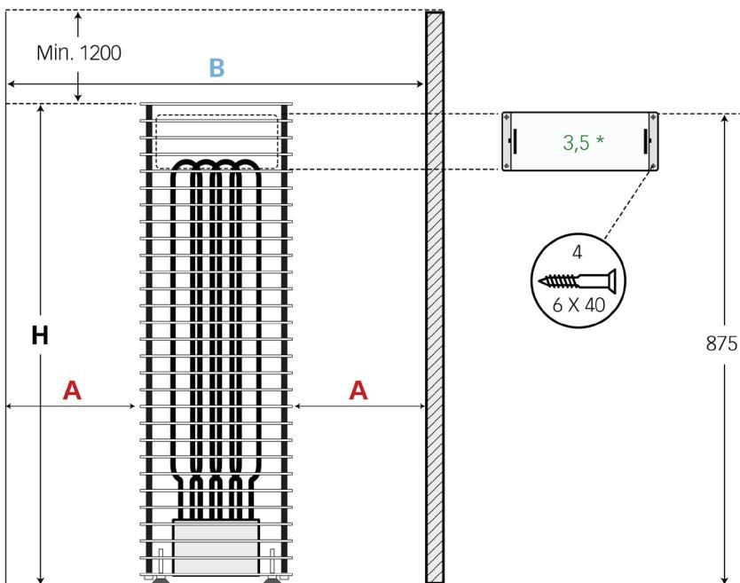
\* CLIFF 3,5 mocuje się do ściany za pomocą specjalnego wspornika
